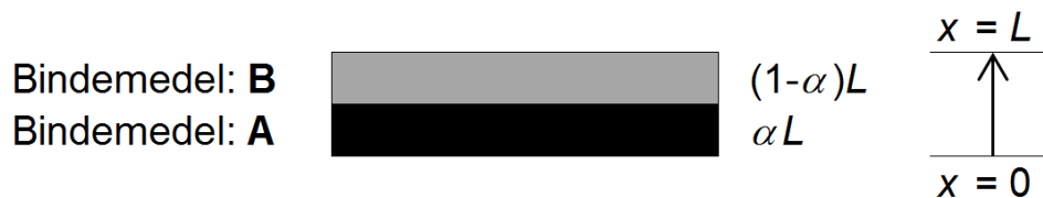
Figur 5. Provning av diffusion i skjuvreometer: definition av geometri och koordinatsystem.
